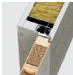
Odwrotna przylga (otwierane do wewnątrz) - drzwi lewe
