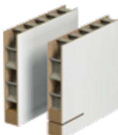
Przygotowanie skrzydła do skrótu - maksymalnie 60 mm
